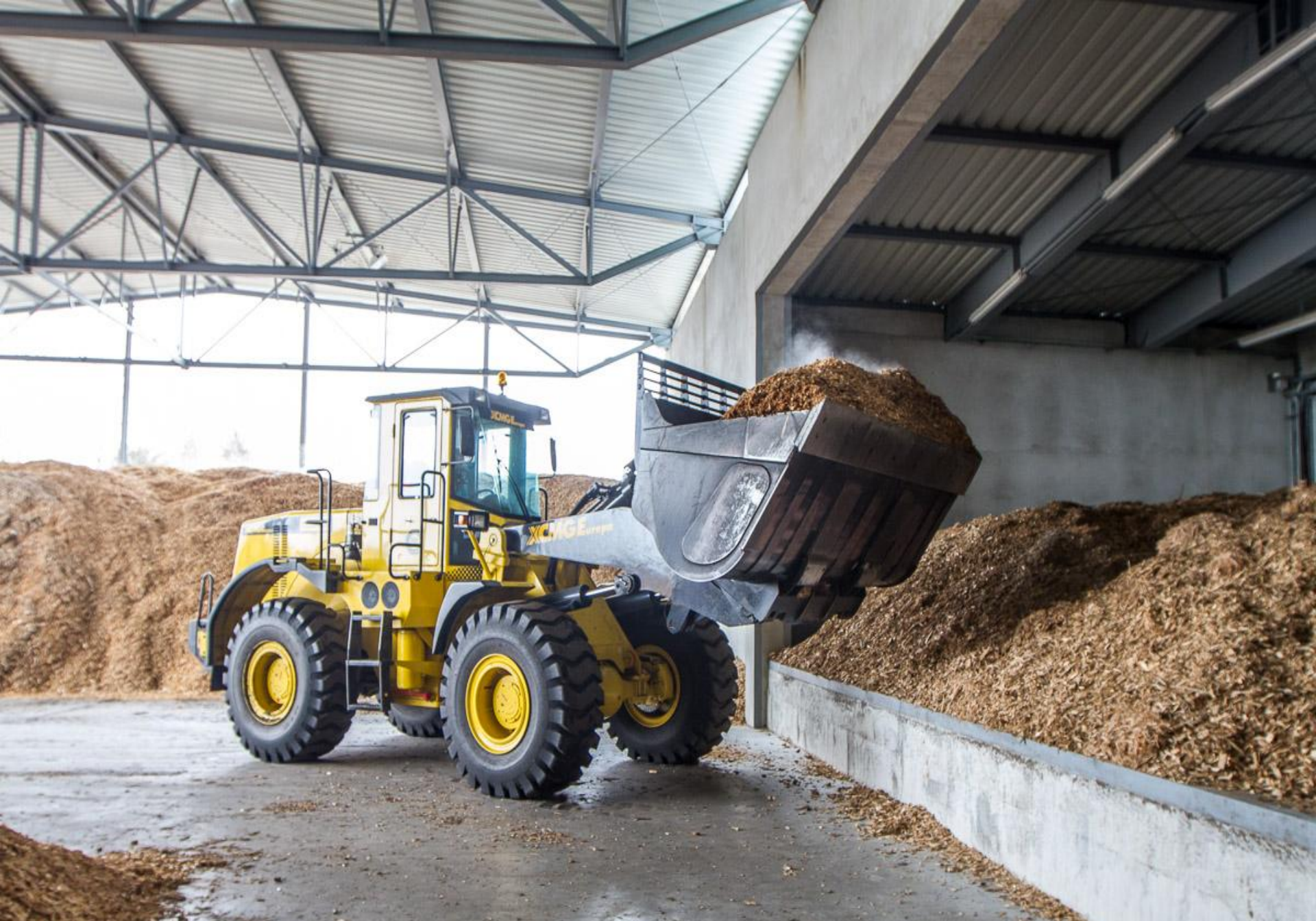
Załadunek biomasy do zasobnika dobowego z podajnikiem.
